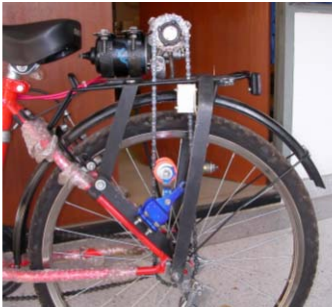
รูปที่ 3.5 โช้ทำหน้าที่เป็นตัวส่งกำลังจากมอเตอร์ไปยังล้อหลัง
