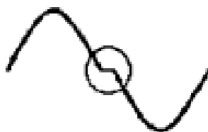
รูปที่ 2.11 แสดงการเกิด Crossover distortion
