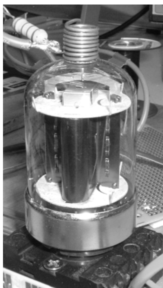
รูปที่ 4.7 หลอดสูญญากาศ 6146B ของจริง
