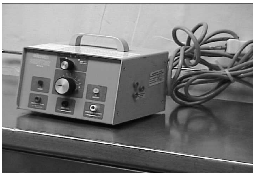
รูปที่ 2.1 ตัวเครื่อง Electrosurgical Generator ต้นแบบ
