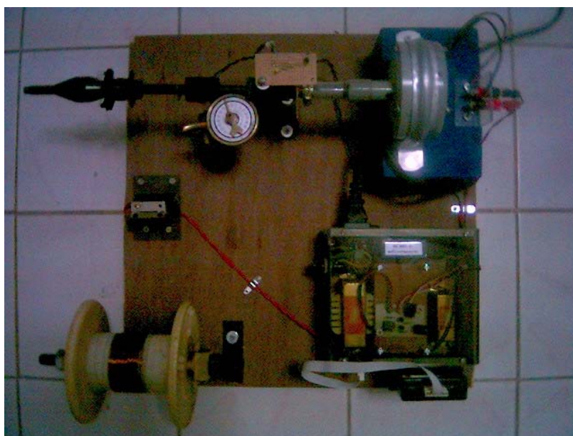
รูปที่ 27. เครื่องผันขดลวดที่เสร็จสมบูรณ์
